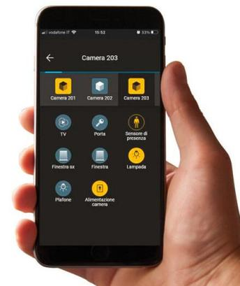
Il sistema dispone di un'APP (disp. su iOS e Android) per le programmazioni (che dovranno essere fatte localmente sull'impianto) e di un'APP per la gestione remota delle camere agendo direttamente sulle serrature delle porte o visualizzandone lo stato di presenza del cliente.
